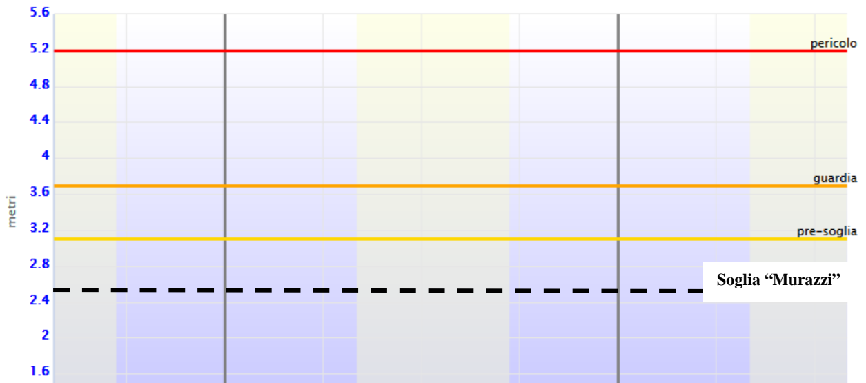
Indicazione dei livelli di pre-soglia (livello 1), guardia (livello 2) e pericolo (livello 3) in corrispondenza della stazione idrometrica di Carignano Po
