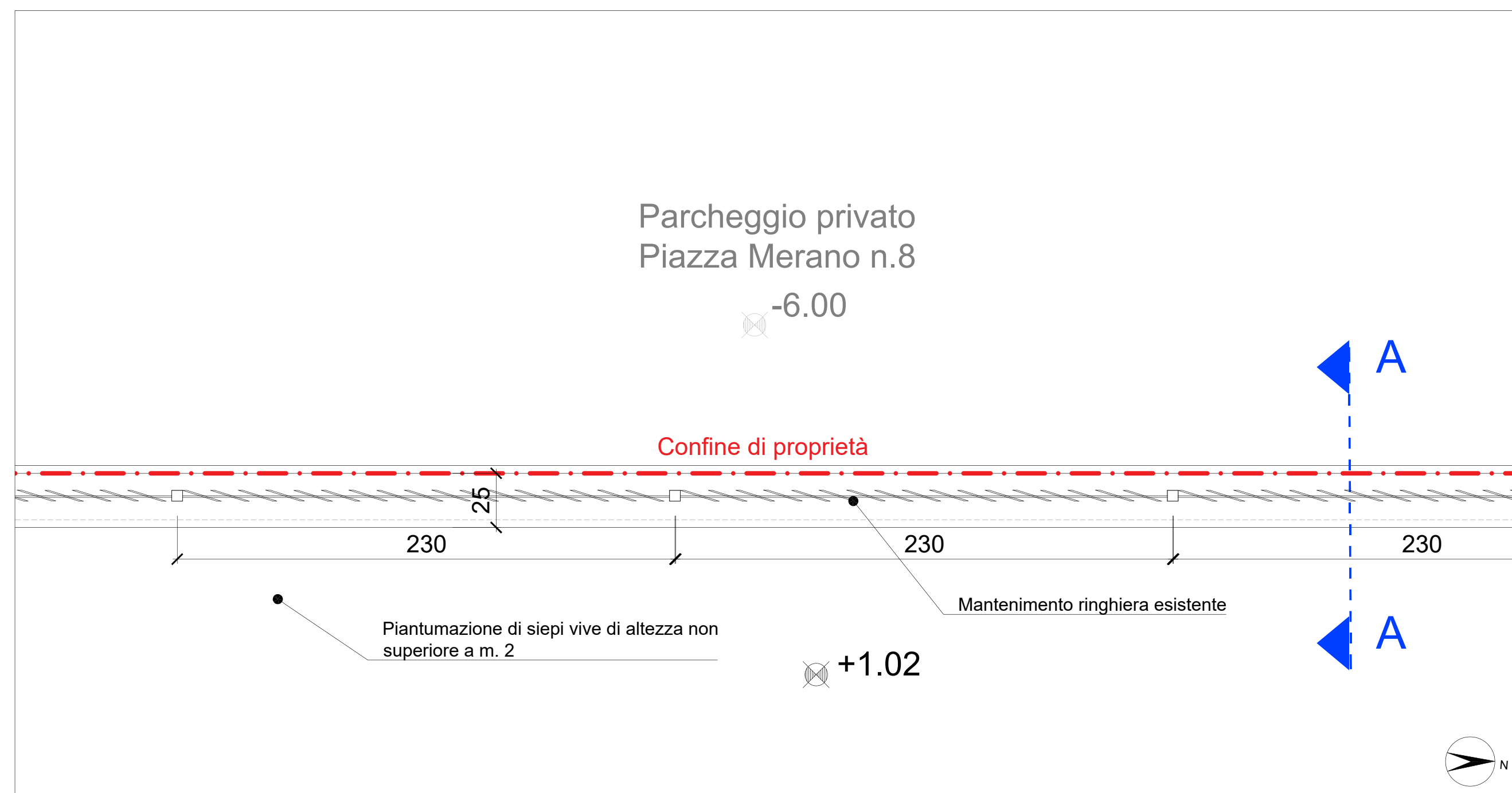
Recinzione della proprietà, pianta - scala 1:20
