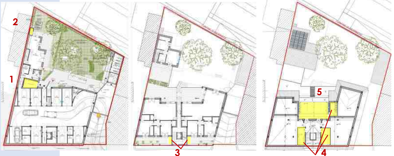
Individuazione dei locali tecnici (esclusi da SLP) in corrispondenza dei piani: seminterrato, piano primo (livello +6.58) e piano sottotetto.
