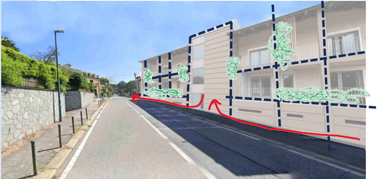
Studio del prospetto finalizzato alla conservazione del filo edilizio su strada e confronto con l'esistente
