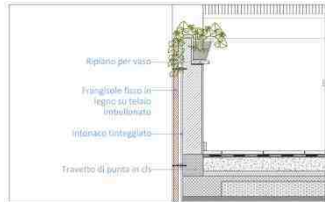
B Tipologia B: parapetto in muratura con ancoraggio per frangisole continuo su facciata
