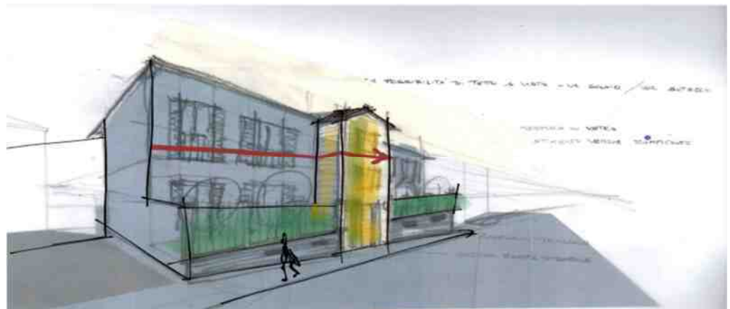
Studio del fronte e del filo del fabbricato su via Sabaudia. Si evidenzia la volontà di mantenere il vano scala sul filo stradale e realizzare delle recinzioni con verde rampicante
