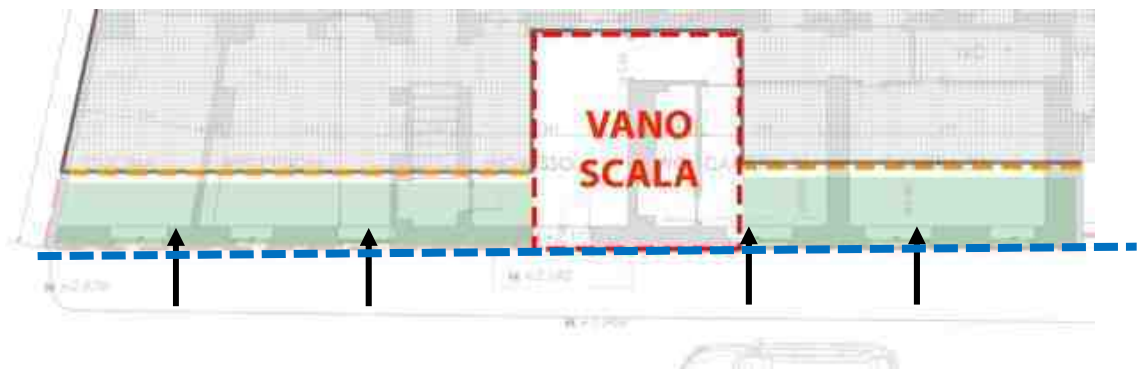
Modifica del profilo del fabbricato su strada. Si evidenzia in rosso la posizione del nuovo vano scala, in arancione il filo murario del fabbricato in progetto, in verde le aiuole verdi generate dall'arretramento, in blu il profilo strutturale del fabbricato.
