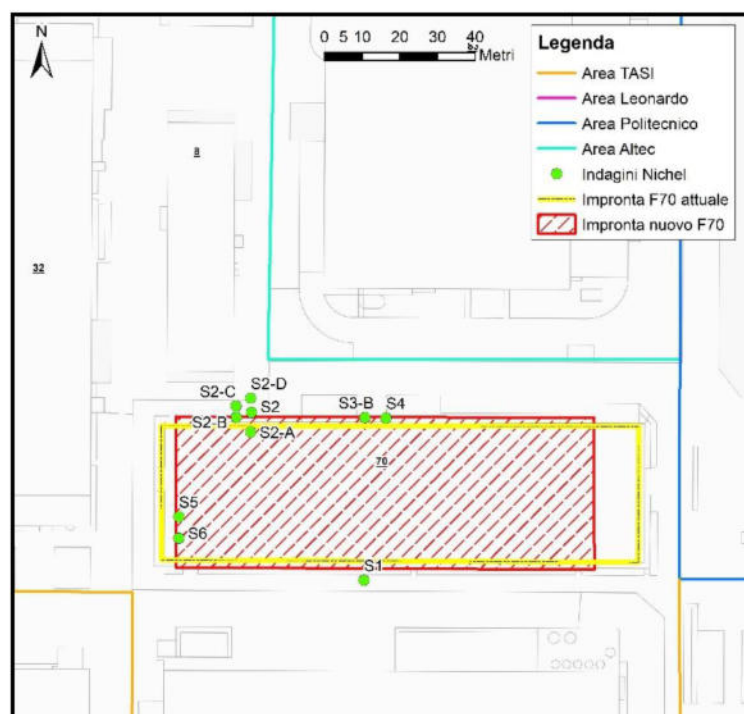
Figura 5: Ubicazione delle indagini eseguite per la verifica del Nichel
