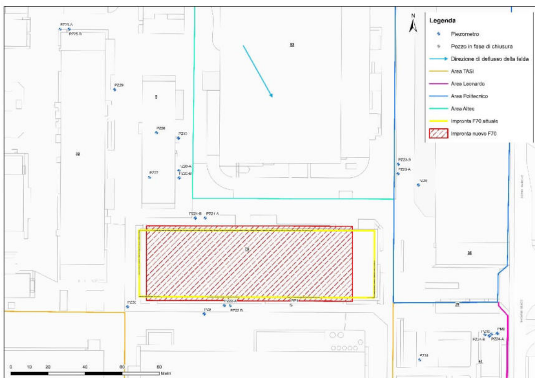
Figura 18: Ubicazione piezometri nell'intorno del F70
