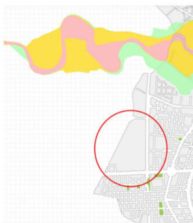
Figura 11: Planimetria con individuazione delle fasce fluviali del PAI (rosa - Fascia A, giallo - Fascia B, verde - Fascia C). In rosso l'ubicazione del Sito
