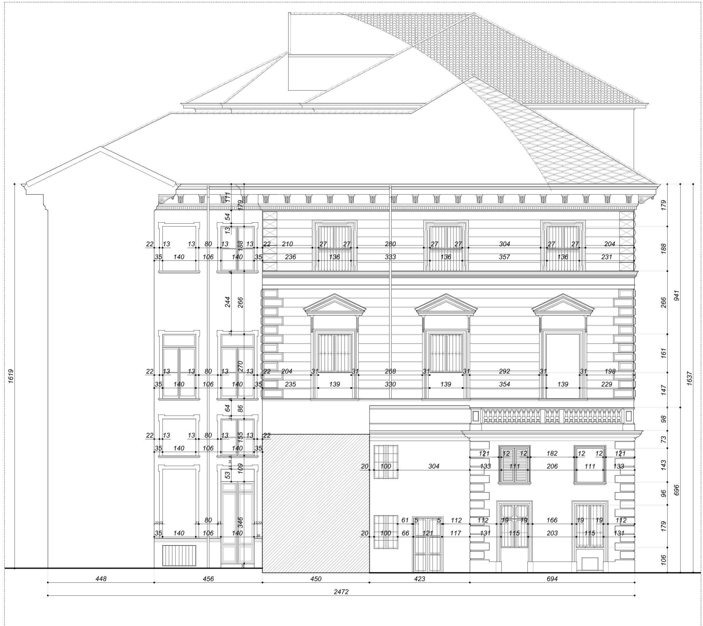
03 Prospetto verso Ovest - P03 SCALA 1:100
