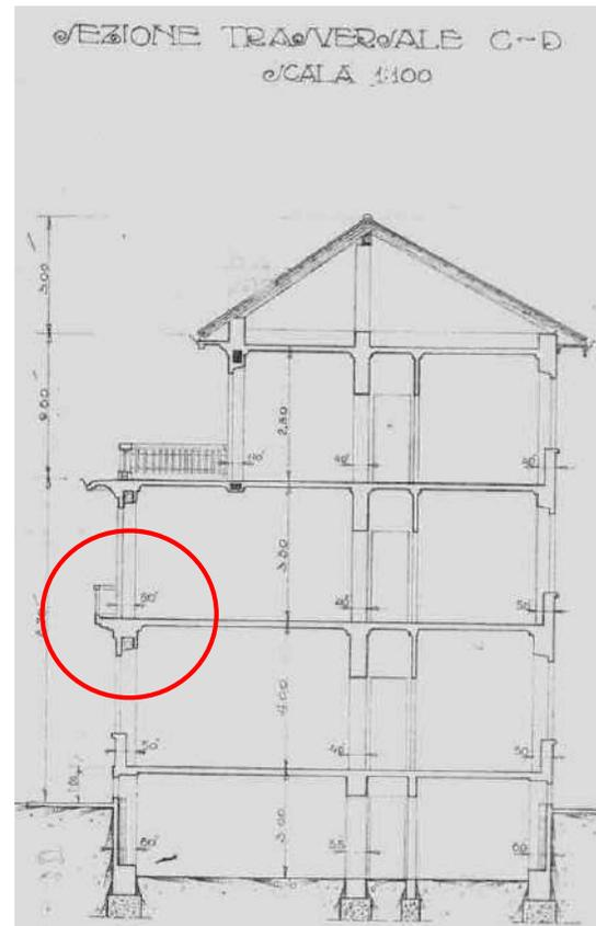
Sezione trasversale allegata al Permesso di Costruire 1929: si nota la presenza del balcone
