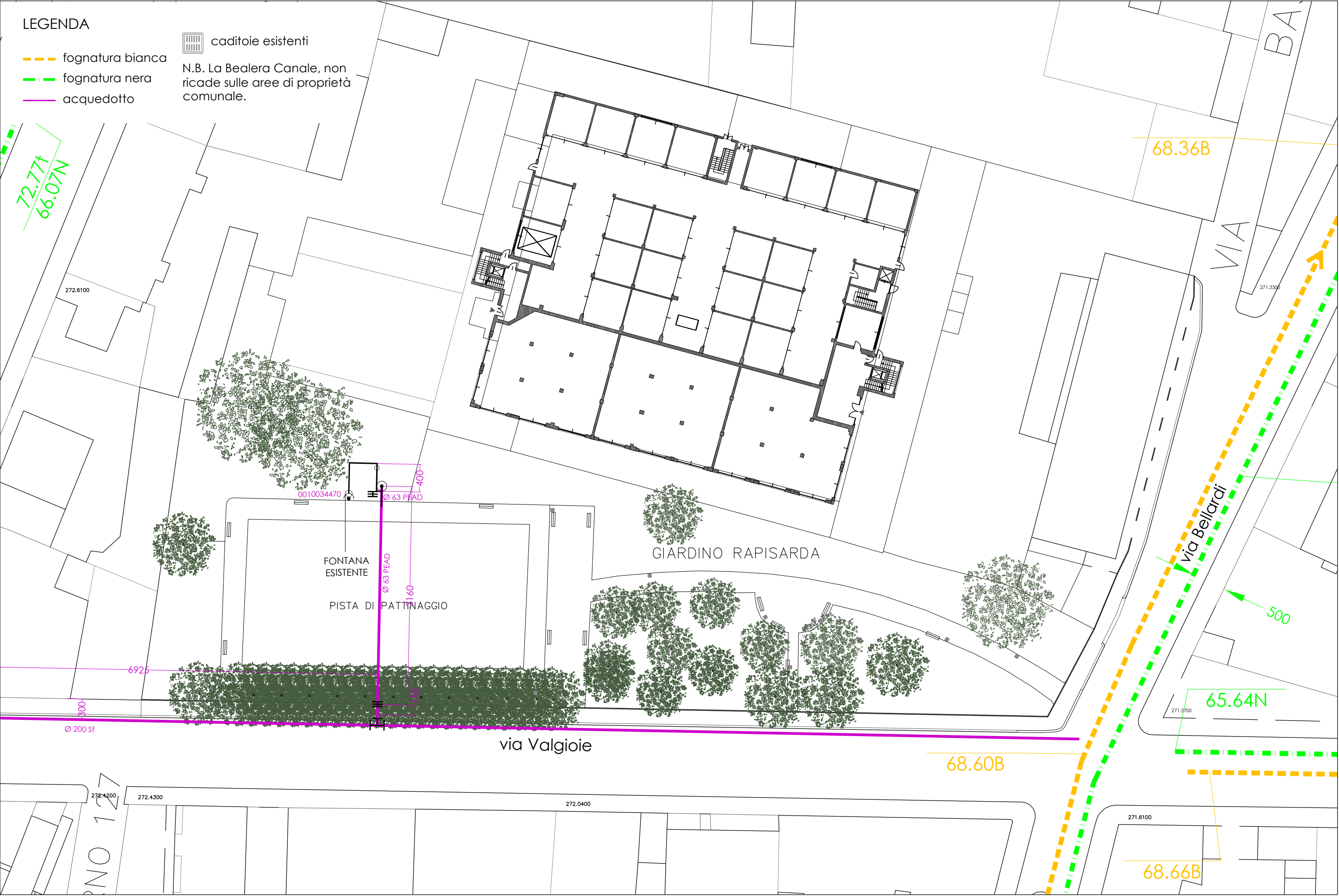
TAV. 06a - Planimetria Stato di fatto - Fognature bianche e nere esistenti - scala 1:500 - Area via Bellardi
