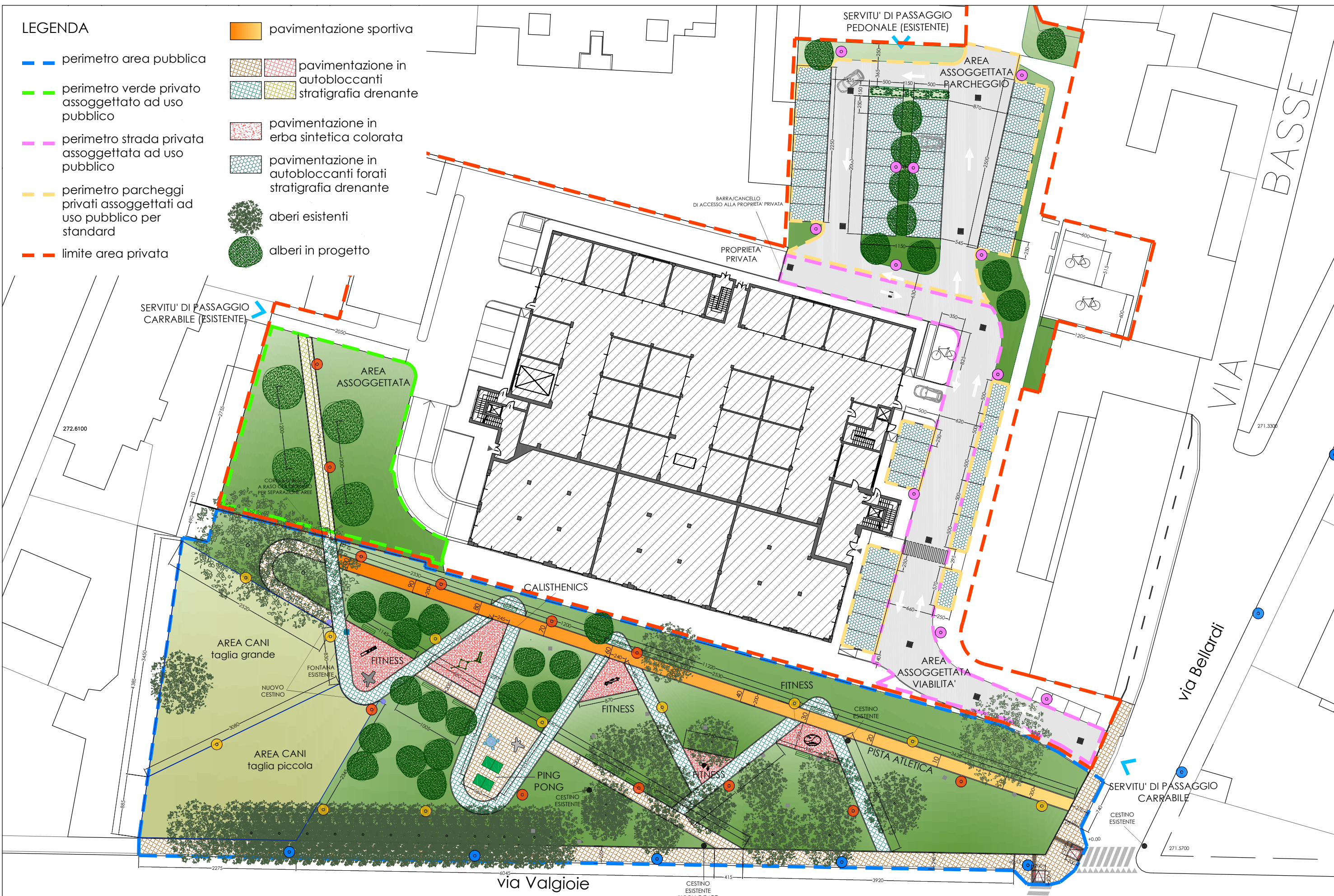
TAV. 03 - Planimetria di Progetto - scala 1:500 - Area via Bellardi
