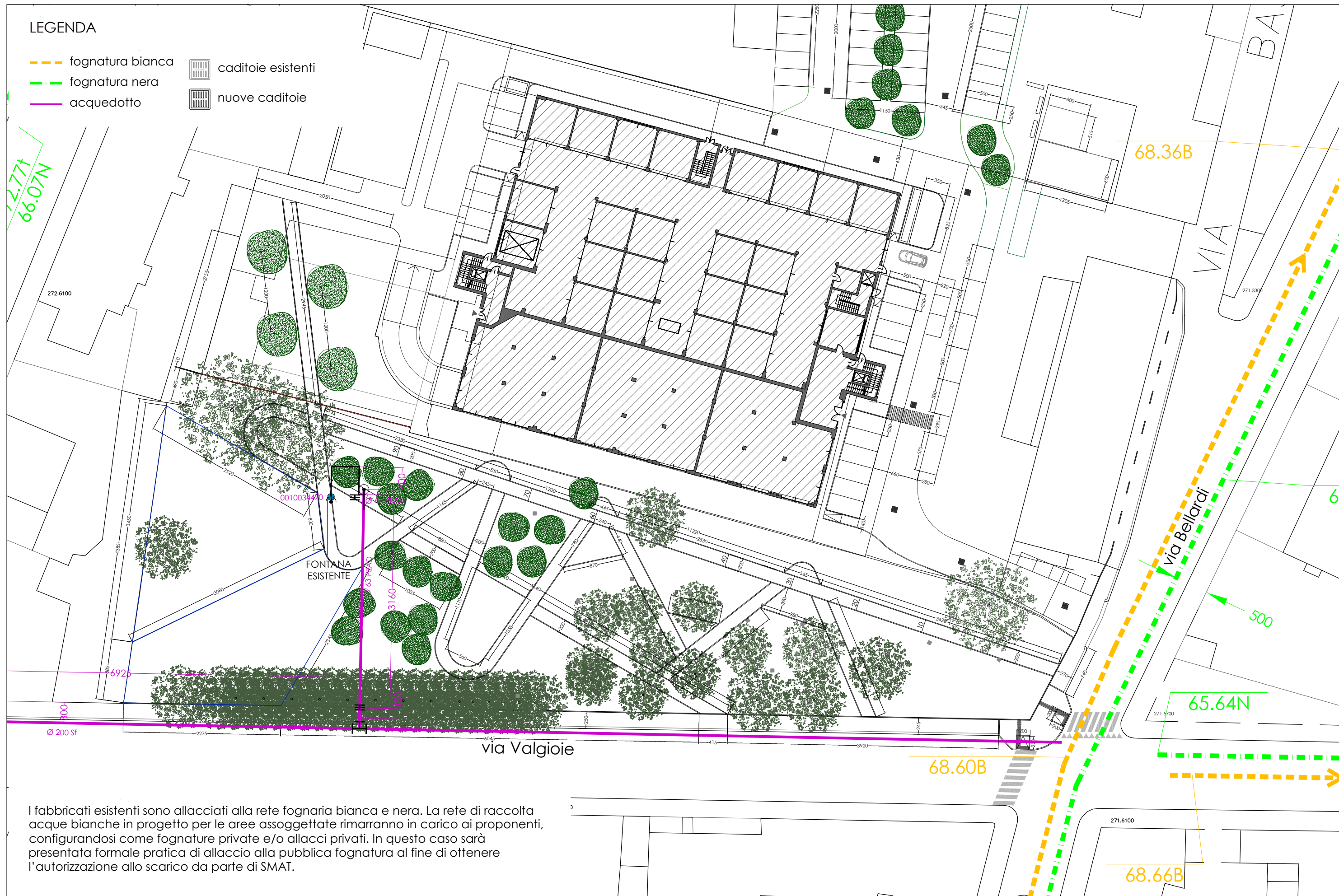
TAV. 06b - Planimetria di Progetto - Fognature bianche e nere esistenti - scala 1:500 - Area via Bellardi
