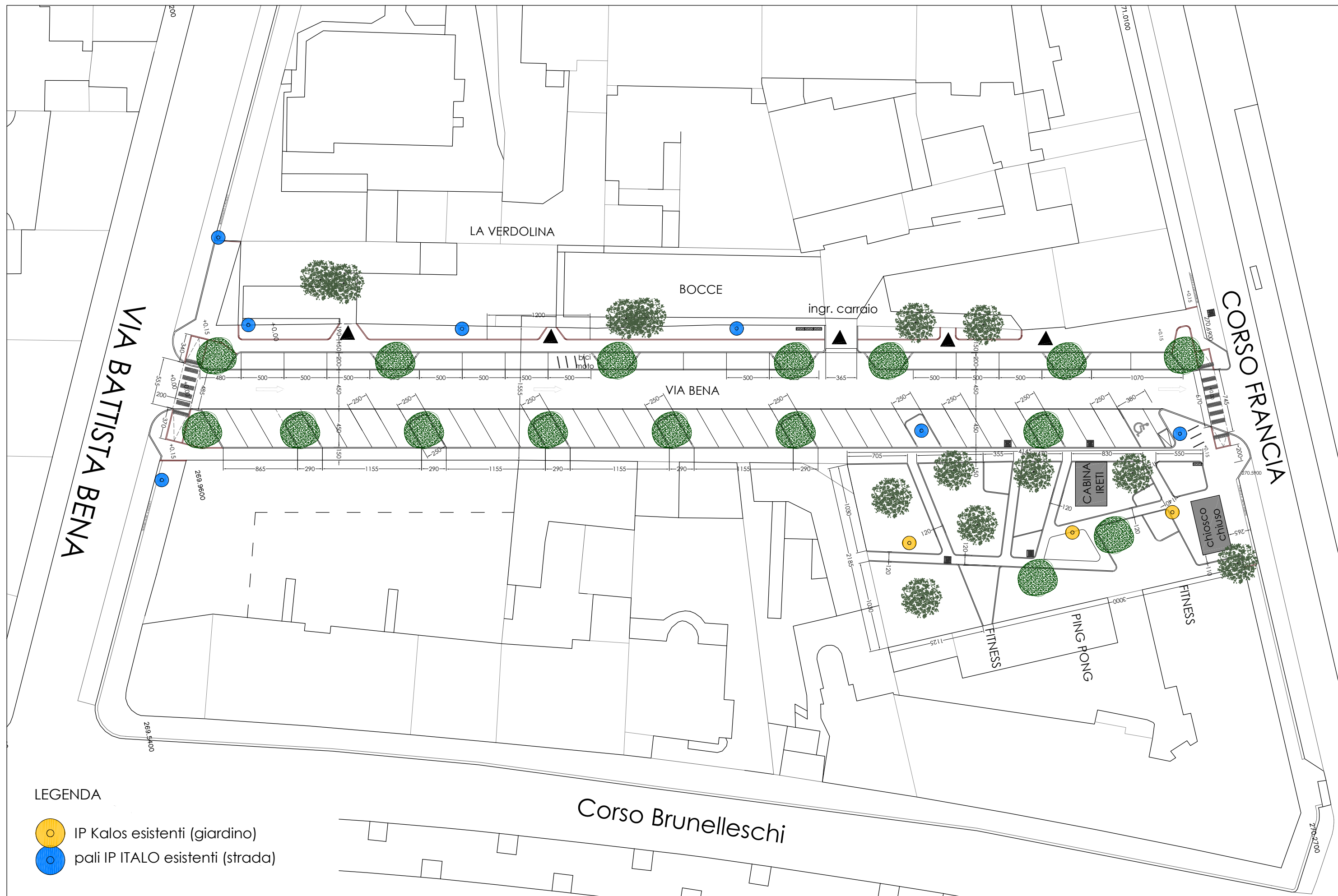
TAV. 17 - Planimetria di Progetto - Illuminazione esistente - scala 1:500 - Area via Bena
