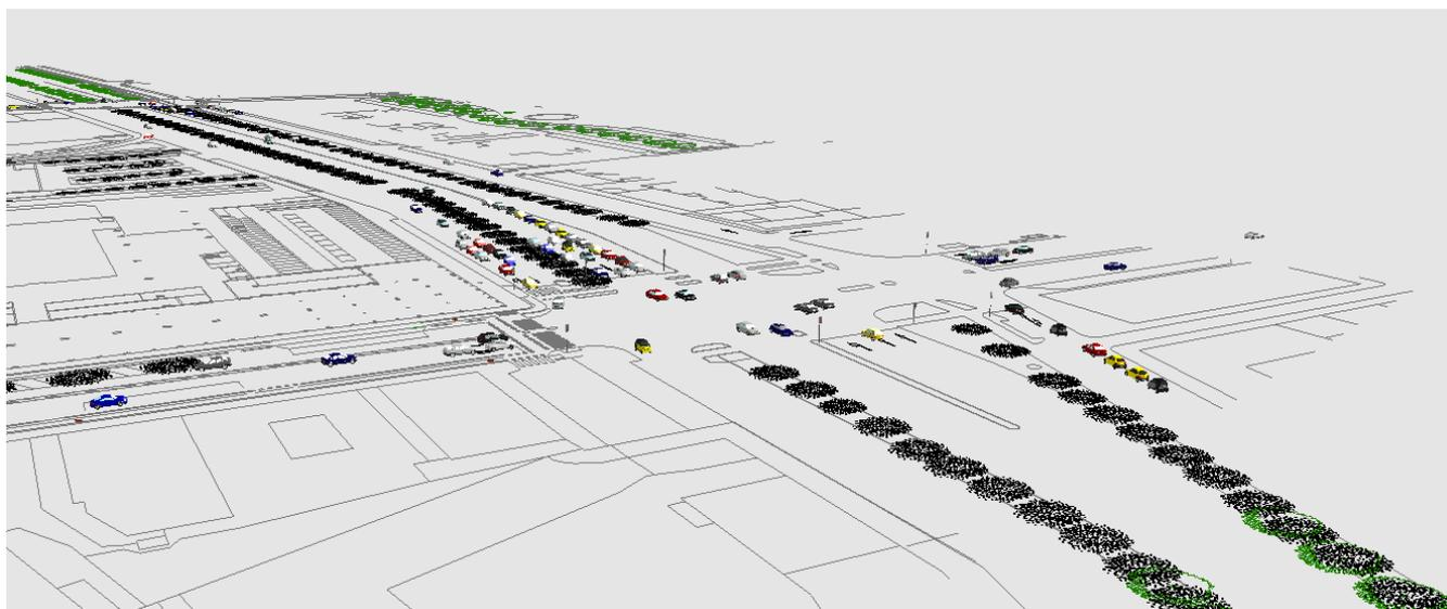
Figura 81 - Scenario di intervento – Intersezione 3 – Istantanea dopo 30 minuti di simulazione
