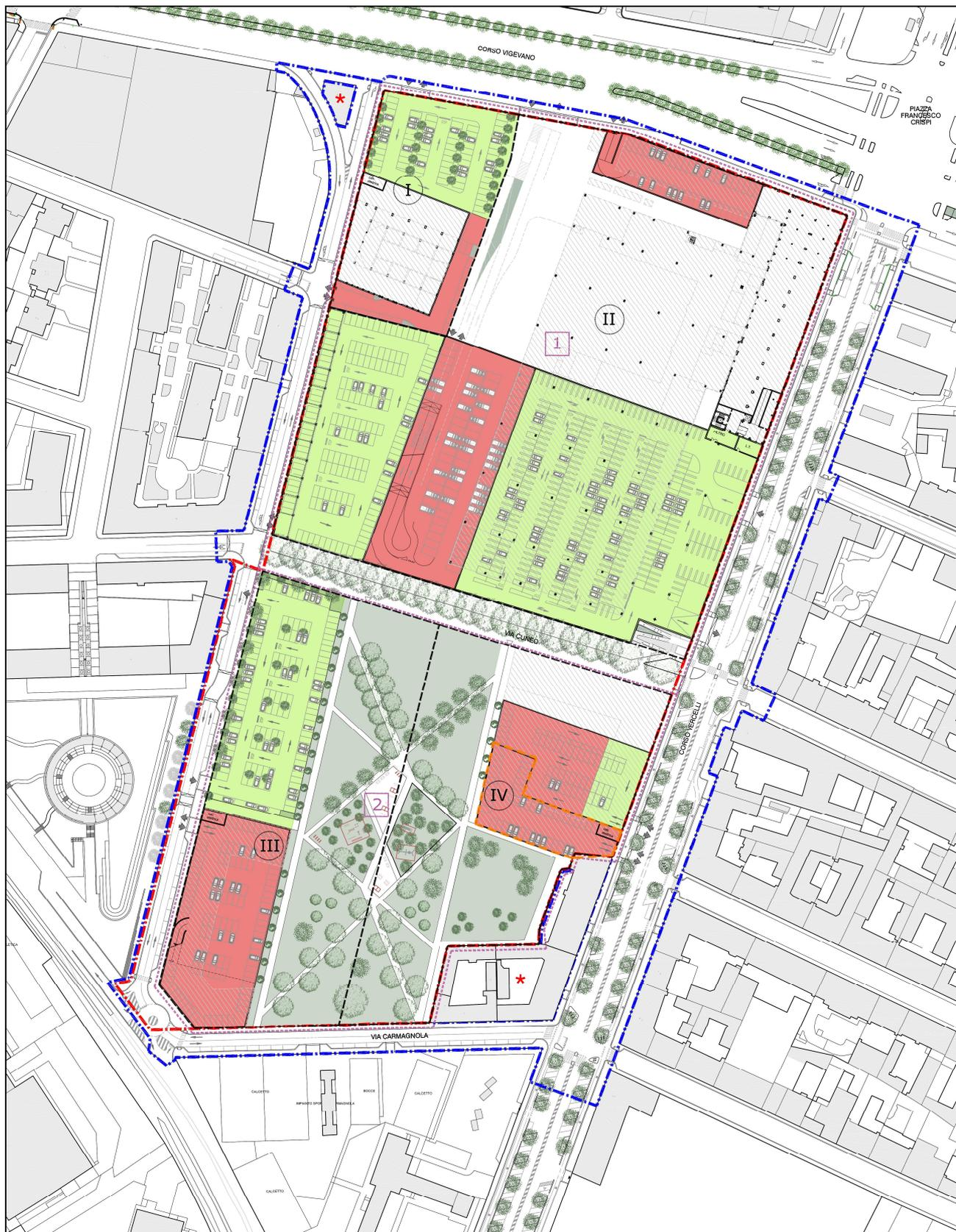
Figura 38 – Identificazione aree a parcheggio e relativa regolamentazione
