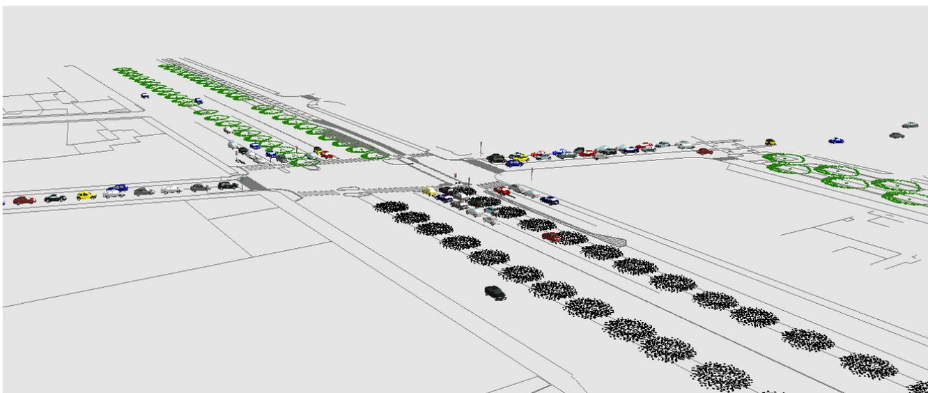
Figura 70 - Scenario di intervento - Intersezione 1 - Istantanea dopo 45 minuti di simulazione
