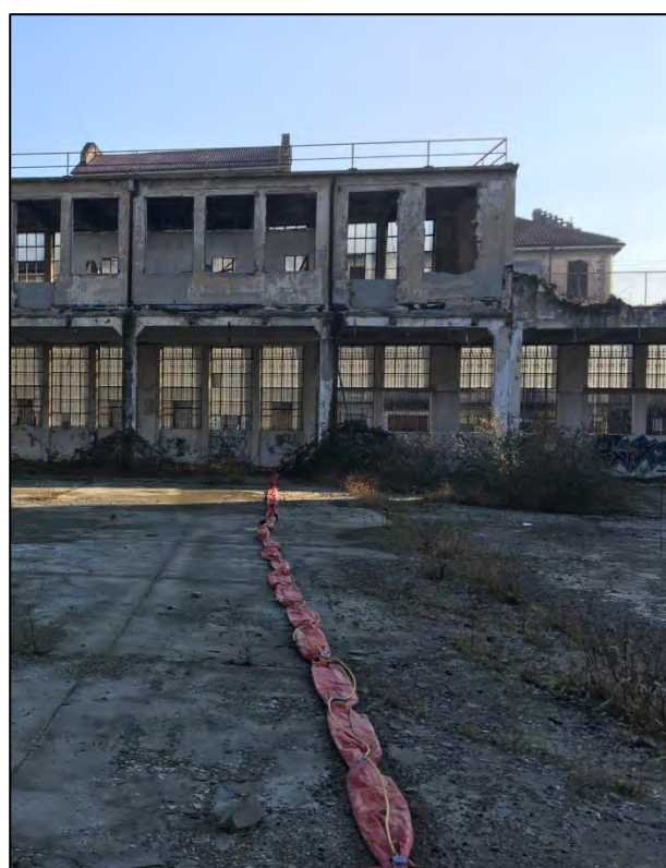
Figura 2 – Stendimento mobile per acquisizione di dati sismici per onde di superficie utilizzato
