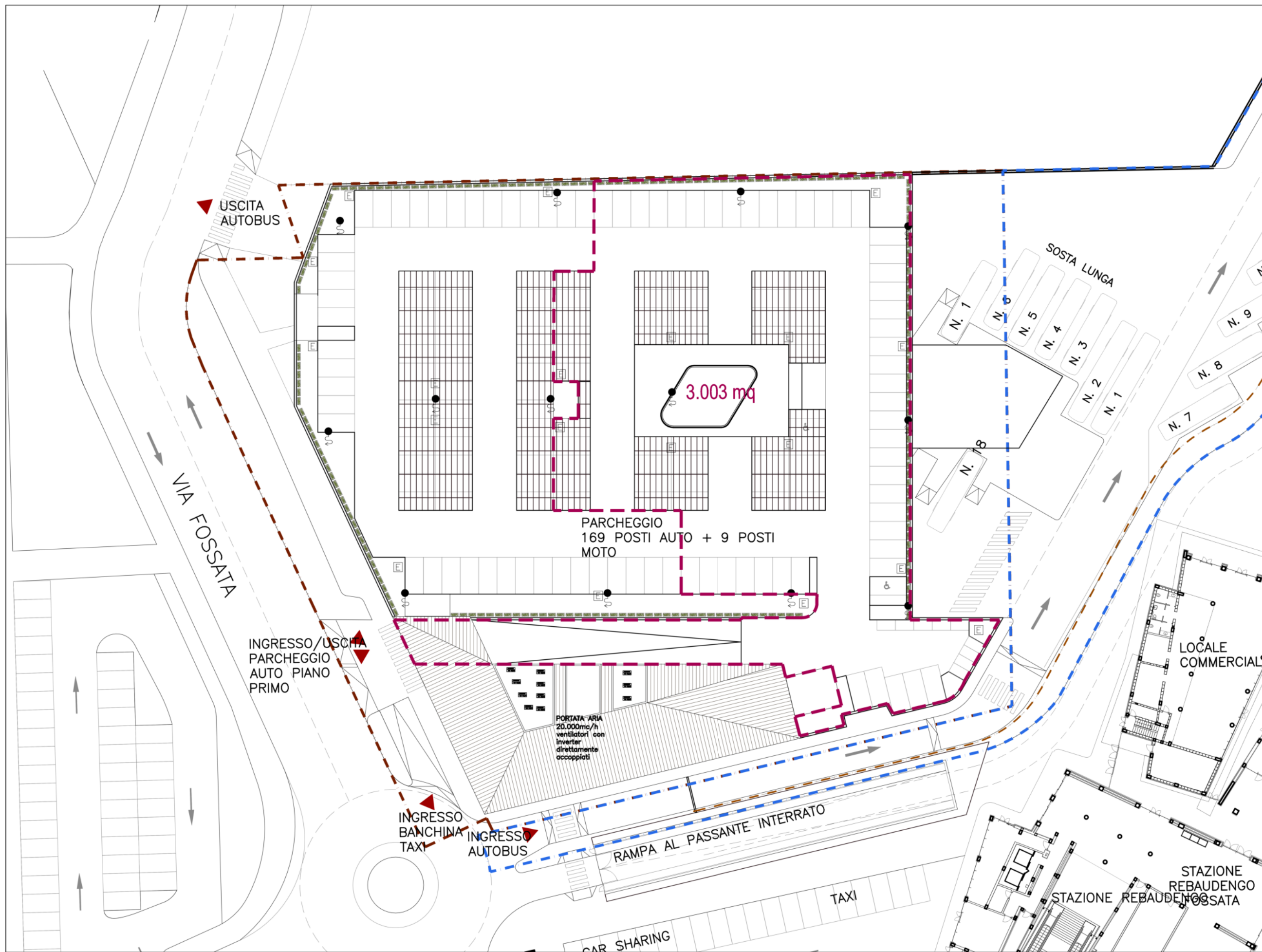
16 - PARCHEGGIO ASSOGETTATO - PLANIMETRIA ANTINCENDIO: IDRANTI, ESTINTORI- SCALA 1/500
