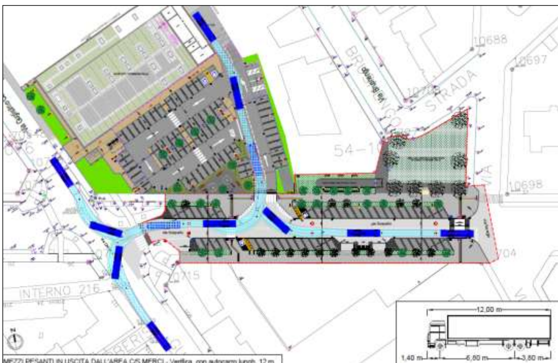
Fig. 9 - Verifica ingombro sagome dinamiche mezzi pesanti - Uscita dall'area c/s
