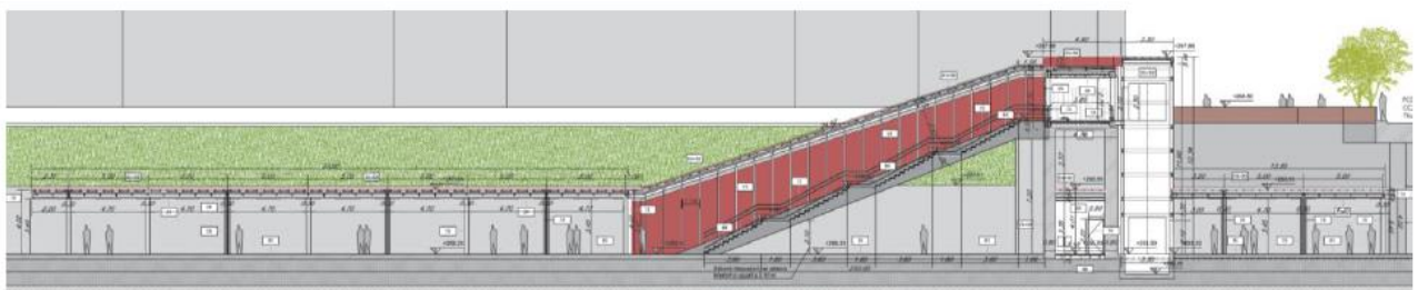
Figura 9: sezione longitudinale banchina centrale
