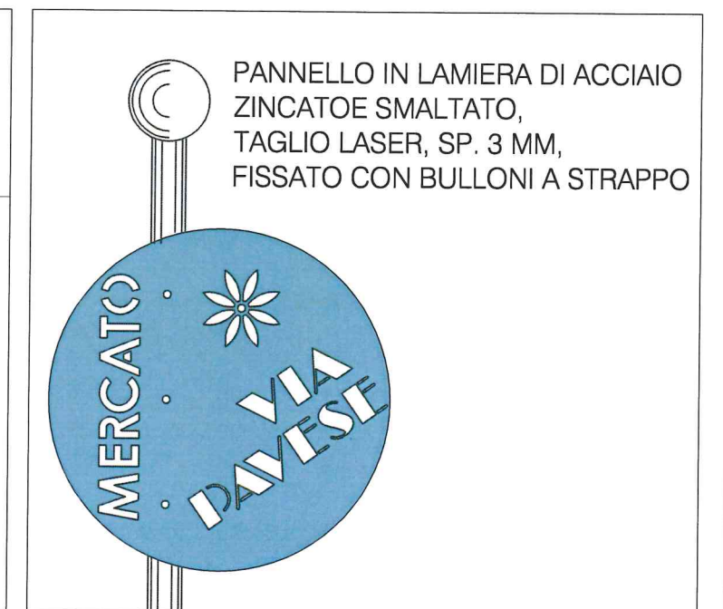
Nuove bandiere segnaletiche in acciaio verniciato
