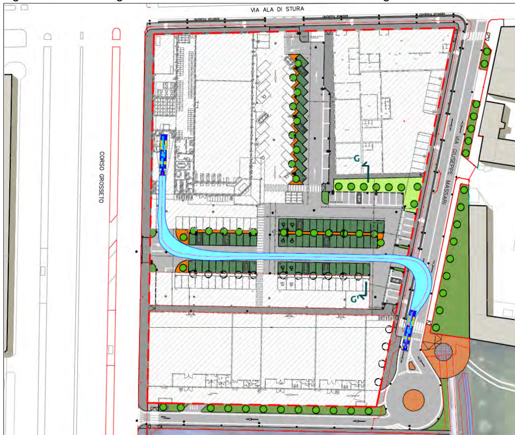
Fig. 24 – Verifica sagoma dinamica area M-SAM2 - L=16.50 m - Ingresso
