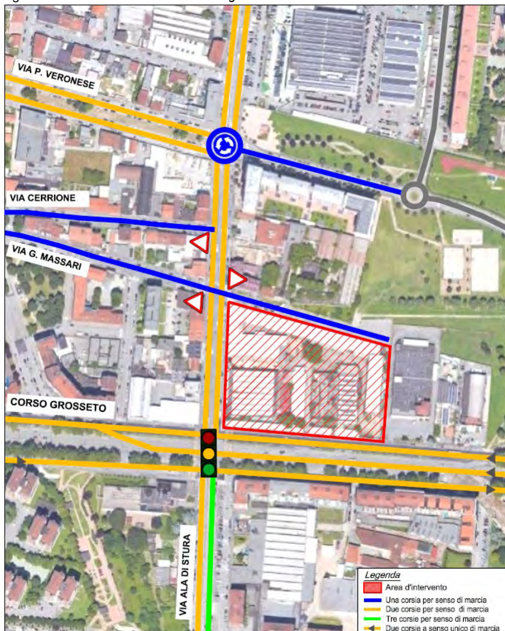
Fig. 8 – Caratteristiche della sezione degli assi stradali nell'area di studio
