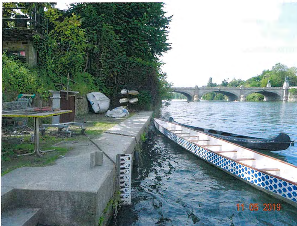
Figura 2-21 – Idrometro esistente alla banchina del Circolo Amici del Fiume, spesso citato nei documenti del Civico Ufficio tecnico (foto 2619- DSC04436)
