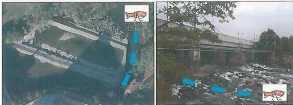
*Figura 3 – Traversa di derivazione del Canale Ceronda con posizione del passaggio di risalita dell'ittiofauna e adeguamento della rampa in massi del ponte ferroviario GTT.*
