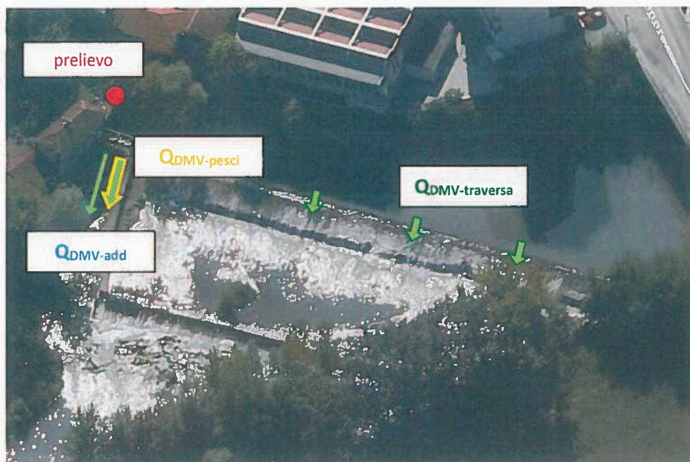
Figura 4 – Schema dei rilasci di acqua a valle del punto di prelievo in qualsiasi condizione di esercizio.
