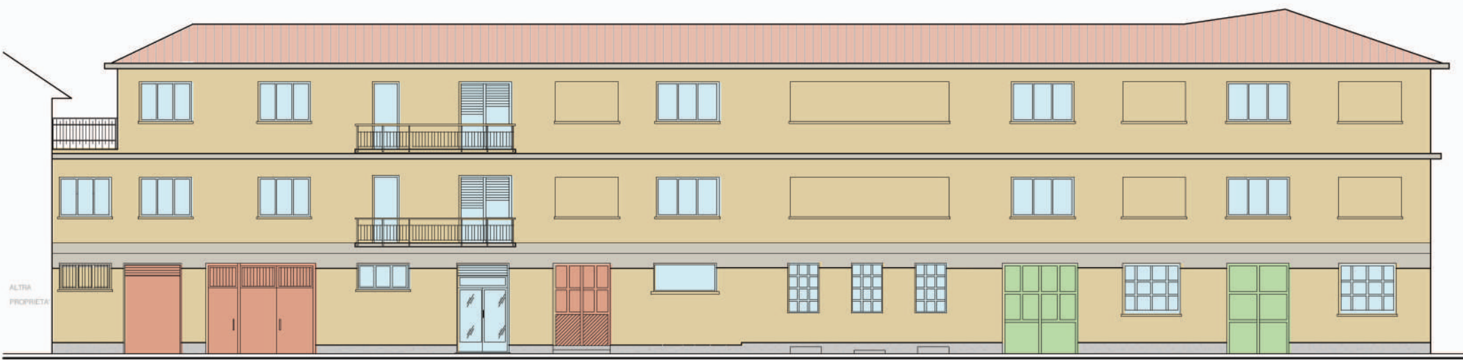
PROSPETTO LATO VIA SESTRIERE ESISTENTE SCALA 1:200
