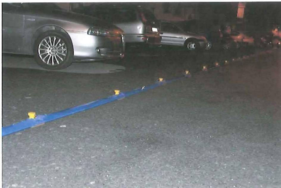
Figura 2 – Dettaglio del land streamer, attrezzato con geofoni ad asse verticale SENSOR SM-6/U-B da 4.5 Hz.
