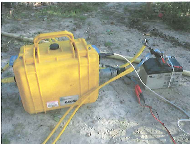
Figura 3 – Sismografo Geometrics Geode (un modulo).
