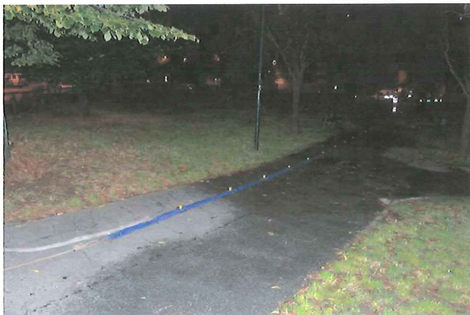
Figura 1 – Land streamer trascinato da automezzo.
