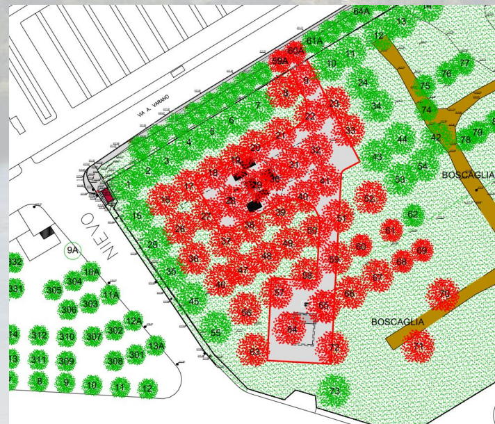
Interferenza con 51 alberi (di cui 34 per attività di bonifica bellica, da eseguirsi prima dell'inizio dei lavori)
