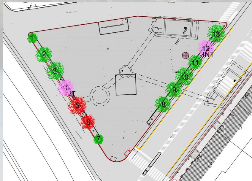
Interferenza con 4 alberi (di cui 4 per attività di bonifica bellica, da eseguirsi prima dell'inizio dei lavori)
