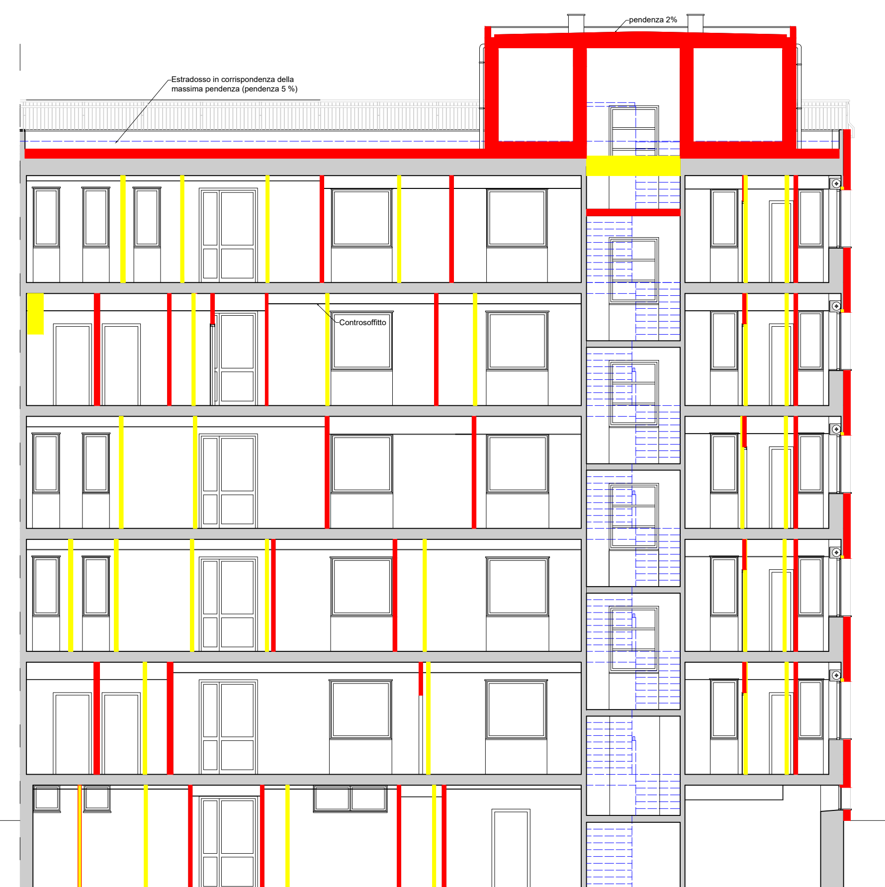
Demolizioni e costruzioni - Sezione AA
