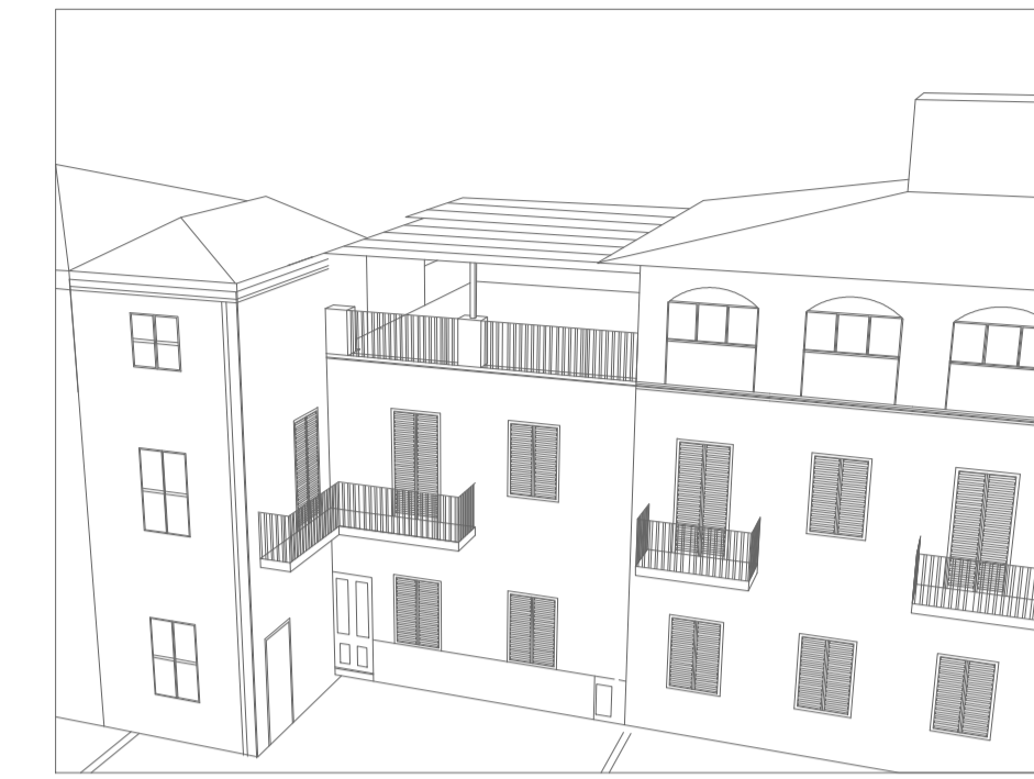
SCHEMA 1 Attuale condizione del sito di intervento, con terrazzo a cielo aperto e pensilina con rivestimento in materiale plastico.
